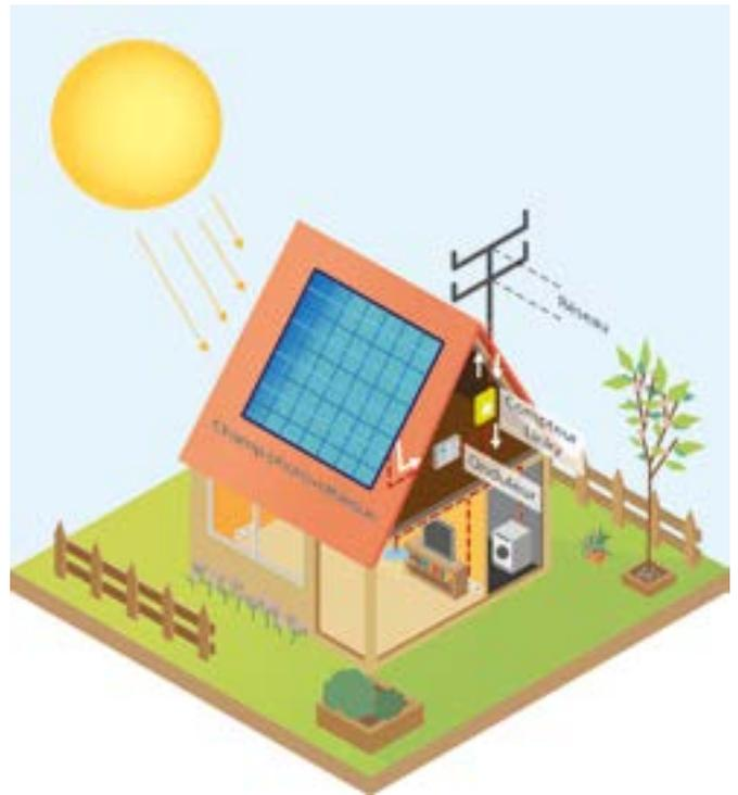
**Bon à savoir.** Une maison équipée de panneaux photovoltaïques **doit rester raccordée au réseau classique et conserver un contrat de fourniture d'électricité** pour pouvoir être alimentée lorsque la production des panneaux ne suffit pas à satisfaire les besoins en énergie du foyer.
